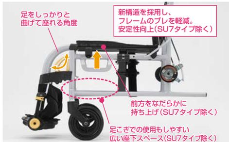
座りの姿勢を理想的に保つ形状の他、使用中のフレームのブレを格段に軽減させる新機構を採用。座下には足こぎ使用時のための広い有効スペースも確保しました。※シート幅調整式SU7タイプを除く
