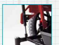
6輪での安定走行を実現するリンク機構とリアサスペンション
