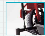
6輪での安定走行を実現するリンク機構とリアサスペンション
